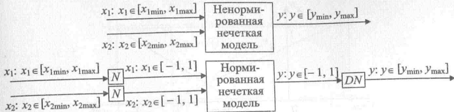
Рис. 5.90. Нормирование входов и выходов модели (N — операция нормирования, x^N — нормированная величина, DN — операция денормирования)
