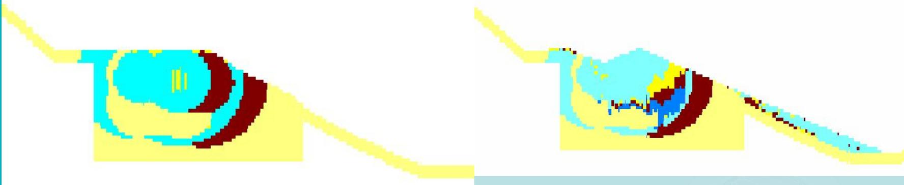
. Перераспределения полезного компонента (Fe мг.) в результате взрыва БВР блока № 91
