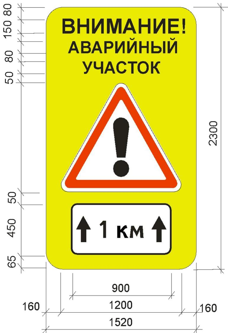
Применение знаков по СТО РДНИИ соответствует Разделу 9 ОДМ 218.4.004-2009 «Руководство по устранению и профилактике возникновения участков концентрации ДТП при эксплуатации автомобильных дорог»
