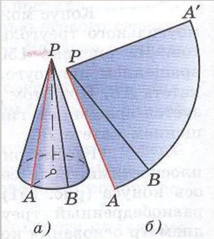
Площадь боковой поверхности конуса равна произведению половины длины окружности основания на образующую.
