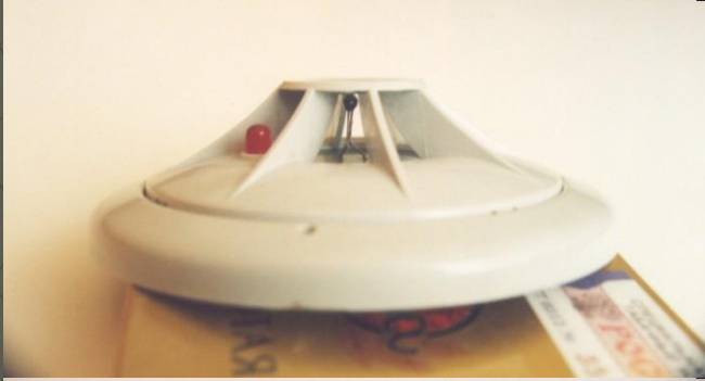
Пожарный извещатель Fire alarm sensor
