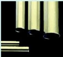
Рисунок 8.1. Бесшовные прецизионные стальные трубы согласно норме DIN 2391, в бесшовном исполнении из холоднотянутого материала: St 37.4 согласно DIN 1630, NBK (нормализованная, охлажденная со светлой поверхностью)
