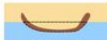
Рис. 23.5. Объем вытесненной лодочкой воды намного больше объема пластилина, из которого она сделана.
