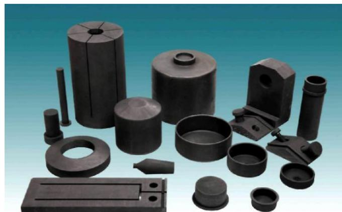
Графит данных марок - мелкозернистый материал, полученный на основе прокалённого пекового кокса. Обладает высокой механической прочностью и низкой зольностью. Это позволяет использовать его при производстве особо чистых материалов. Мелкозернистая структура графита позволяет изготавливать фасонные изделия сложной формы, нарезать мелкую резьбу с шагом 0,5-1,0 мм.
