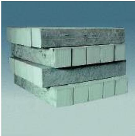
Графитированные блоки квадратных сечений предназначены для электротермических и электрохимических процессов в качестве токопроводов и для футеровки реакционного пространства различных аппаратов. Выпускаемые марки: БГТ (блоки графитированные квадратных сечений, ТУ 48-12-16-86) и БГФ (блоки для футеровки изложниц, ТУ 48-12-29-90)
