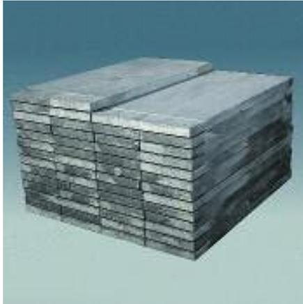
Аноды графитированные (ТУ 48-12-56-89) используются в электролитических ваннах со стальным катодом при получении хлора и хлоратов, каустической соды, в электролизерах для получения надсерной кислоты в производстве перекиси водорода
