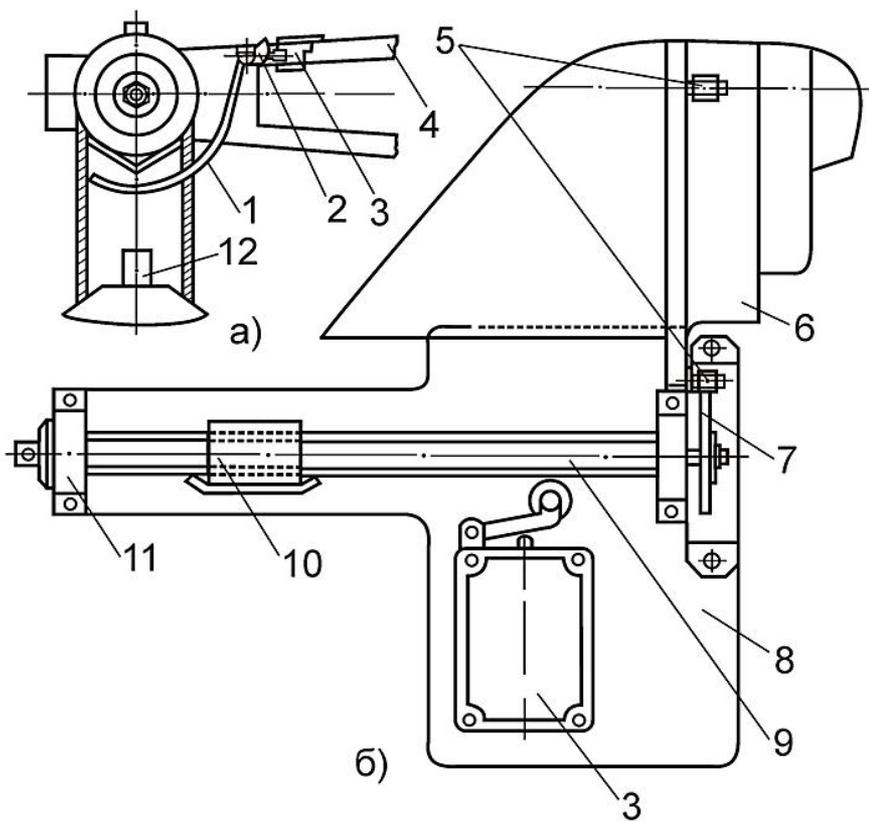
Ограничители высоты подъема крюка крана, устанавливаемые на головке стрелы (а) и барабане (б)
