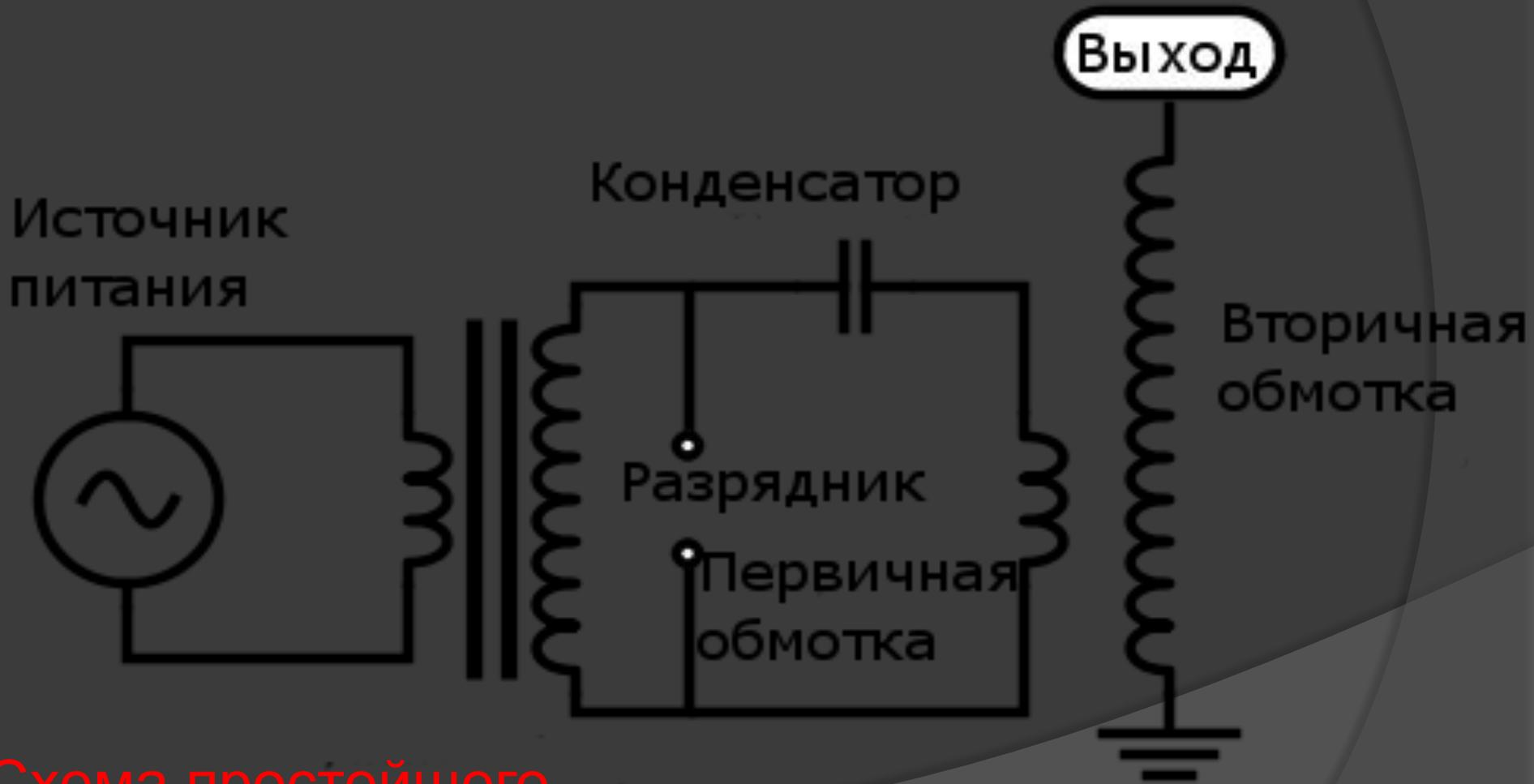
Схема простейшего трансформатора Тесла
