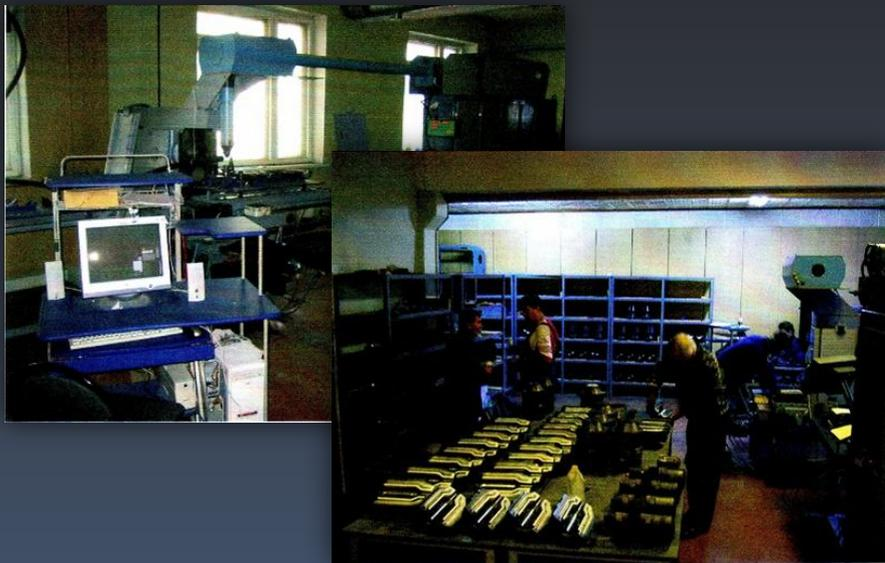
Специализированный лазерный технологический комплекс для термоупрочнения на базе многоканального СО<sub>2</sub>-лазера МТЛ-2 и трехкоординатного технологического поста (с помощью данного комплекса проведена обработка нескольких тысяч вкладышей прессформ для стекольной промышленности)
