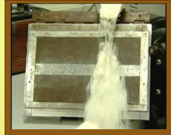
При содержании частиц **элементарного железа** такие частицы могут притягиваться к магнитам...НО...
