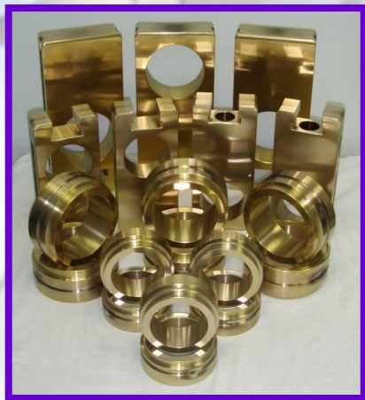
Опытная партия элементов запорно-регулирующей арматуры с покрытием
