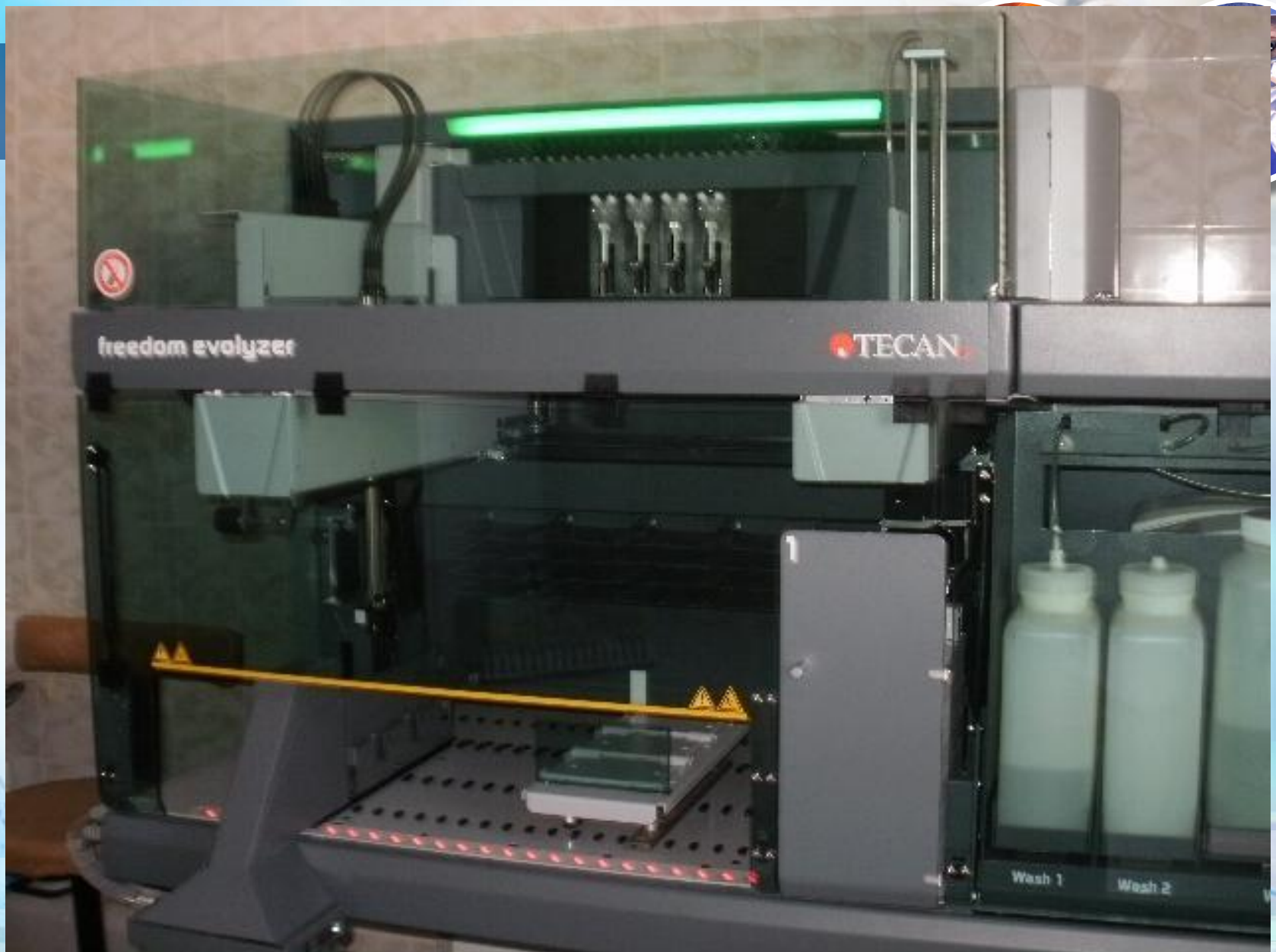
Роботизированная станция «Freedom evo lyzer» по определению анализов иммуноферментным методом
