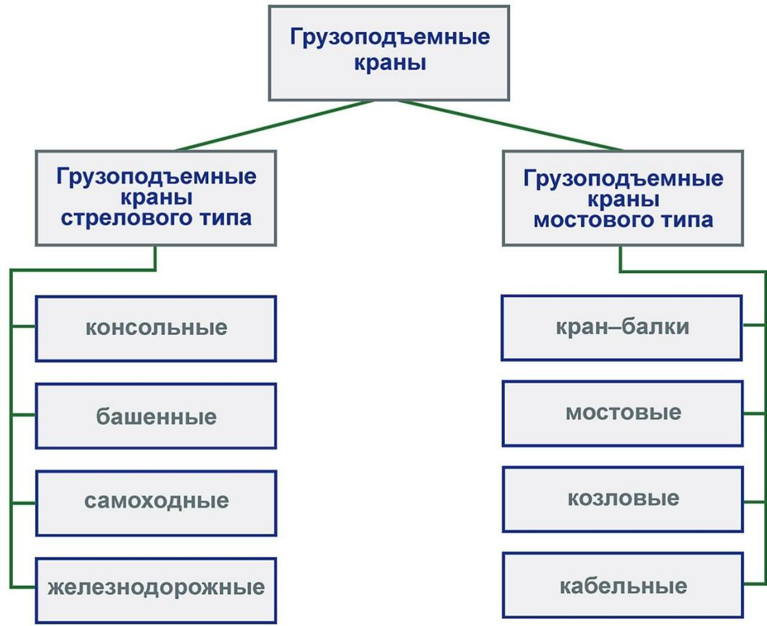
это грузоподъемные машины циклического действия, предназначенные для подъема и перемещения в пространстве различных грузов, подвешенных с помощью крюка. Это наиболее распространенные ГПМ, имеющие весьма разнообразное конструктивное исполнение
