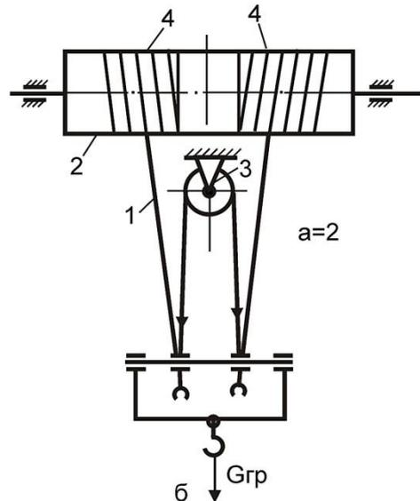
Полиспасты: **а** – **одинарный**: 1-канат; 2-барабан; 3-неподвижная часть конструкции ГПМ; 4-нарезка барабана; **б** – **сдвоенный**: 1- канат; 2-барабан; 3-уравнительный блок; 4-встречная нарезка барабана
