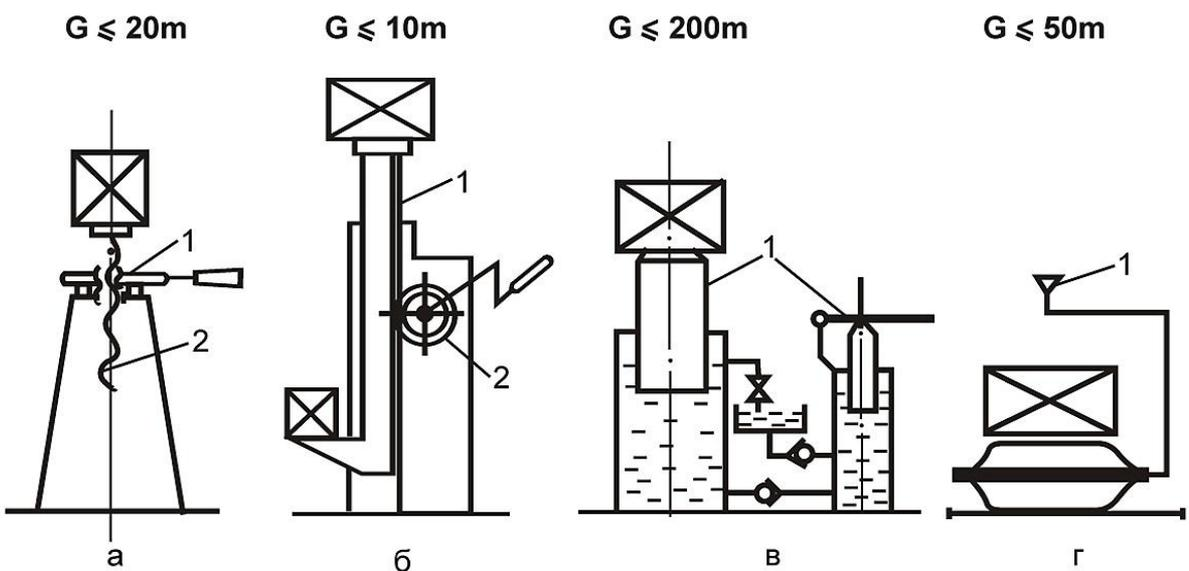
Домкраты: а – винтовой: 1-гайка; 2-винт; б – реечный: 1-зубчатая рейка; 2-шестерня, связанная с рукояткой; в – гидравлический: 1-плунжеры; г – камерный: 1-подвод сжатого воздуха от компрессора, баллона, ногого насоса
