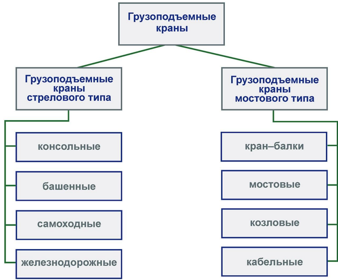
Классификация грузоподъемных кранов
