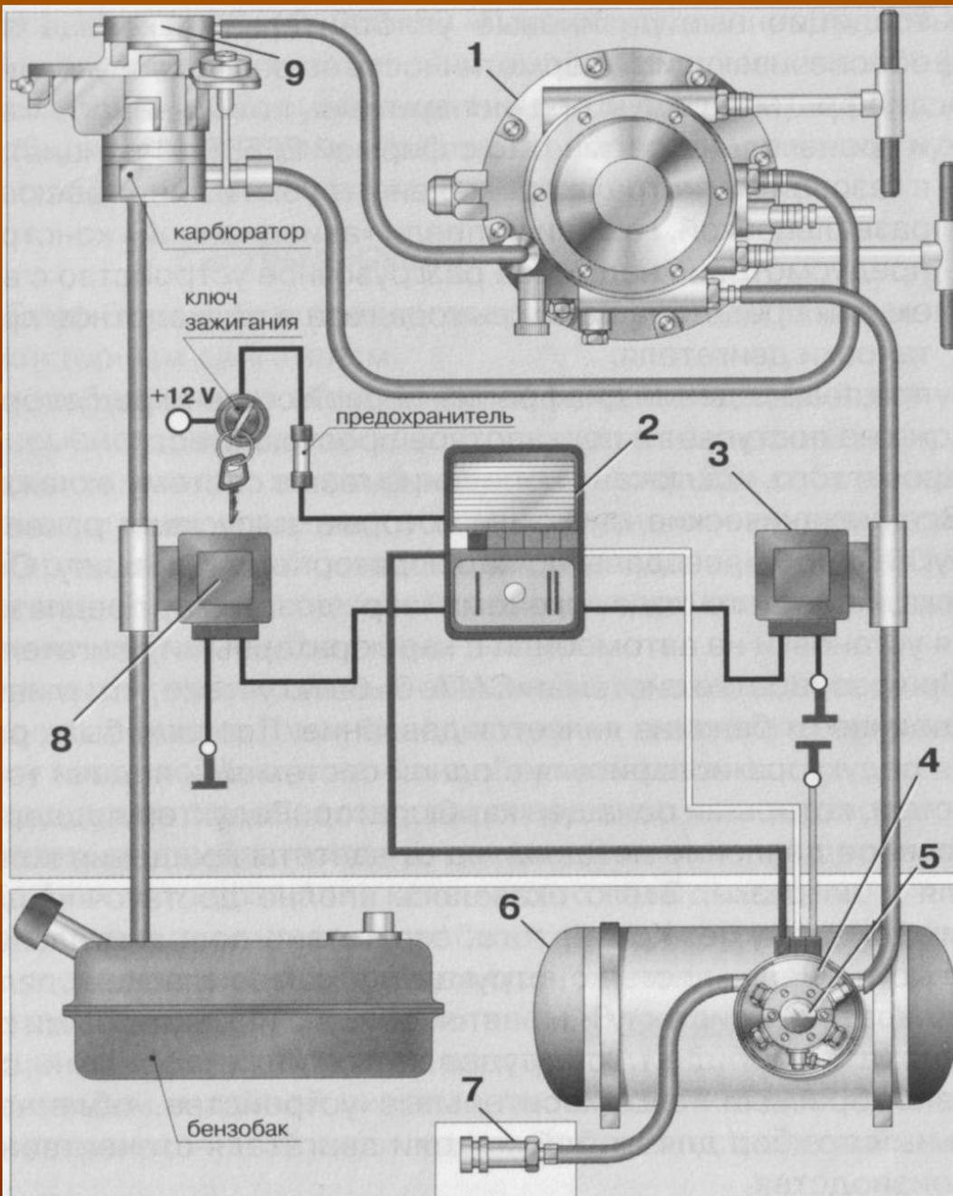
**Схема соединения газовой аппаратуры «САГА -6»:**
