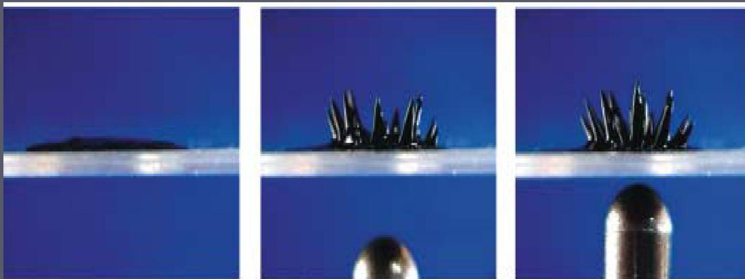
Кадры видеозаписи ферромагнитной жидкости под действием изменяющегося магнитного поля.
