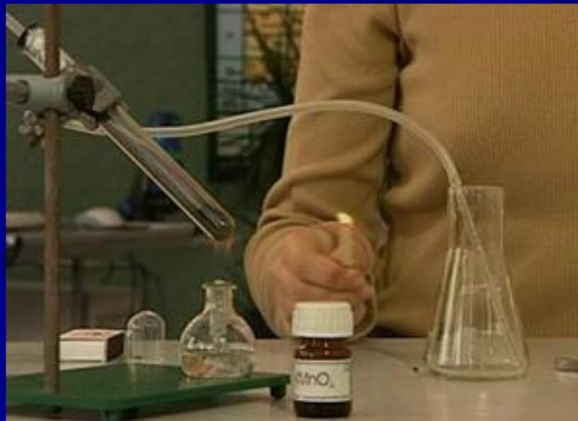
В лаборатории кислород можно так же получать разложением других солей при нагревании
