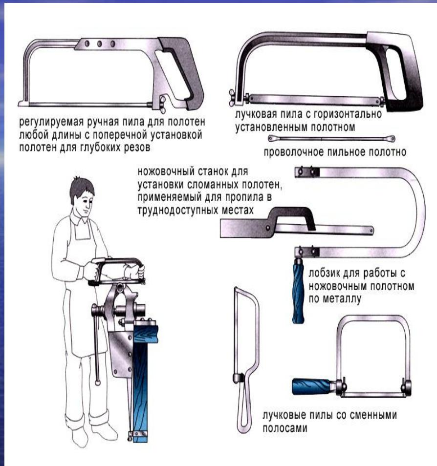
При разрезании длинных заготовок не всегда удается довести резание до конца из-за того, что рамка станка упирается в их торец. Тогда полотно поворачивается по отношению к рамке на **90С** и продолжают работу.
