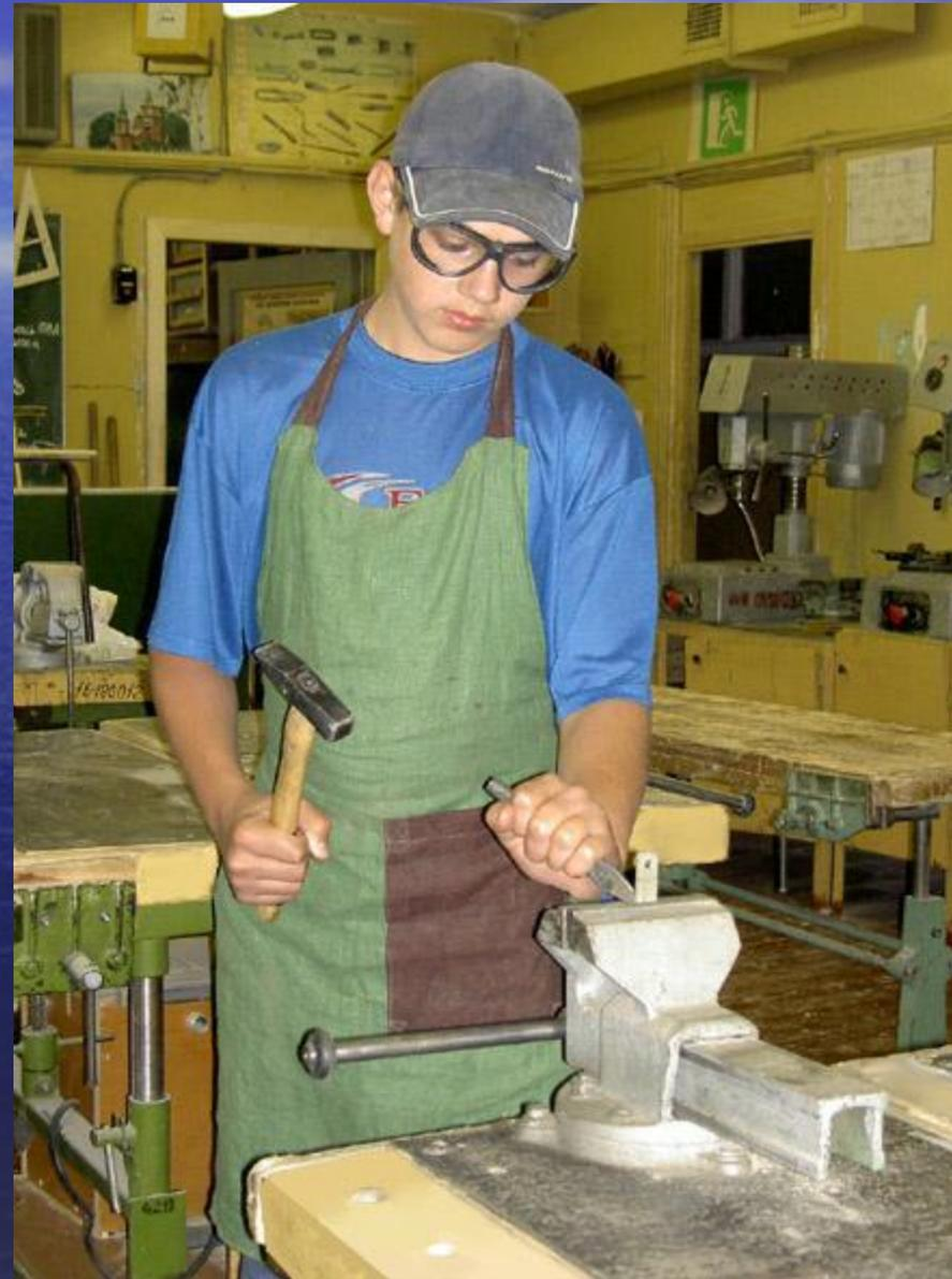
Перед рубкой заготовку закрепляют в тисках немного левее правого края губок, чтобы оставалось место для установки зубила. Молоток бойком влево кладут на верстак справа от тисков, а зубило - слева, режущей частью на себя. На рабочем месте для рубки должна быть установлена защитная сетка(или экран) для защиты окружающих от осколков металла.
