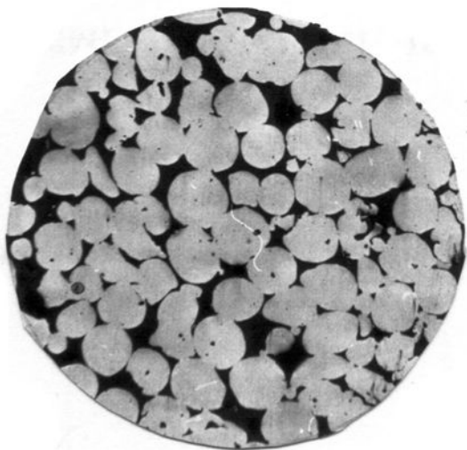
Рисунок 6 - Топограмма фрагмента пористой составляющей фильтрующего элемента
