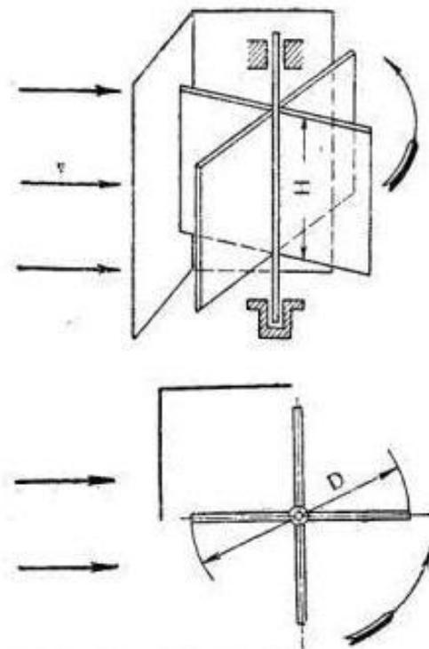
Рис. 38. Схема карусельного ветряка.
