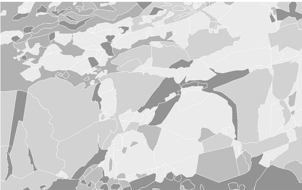
Естественная делимость массива железистых кварцитов блокообразующими системами трещин (юго-западный борт карьера, гор. -115м):
