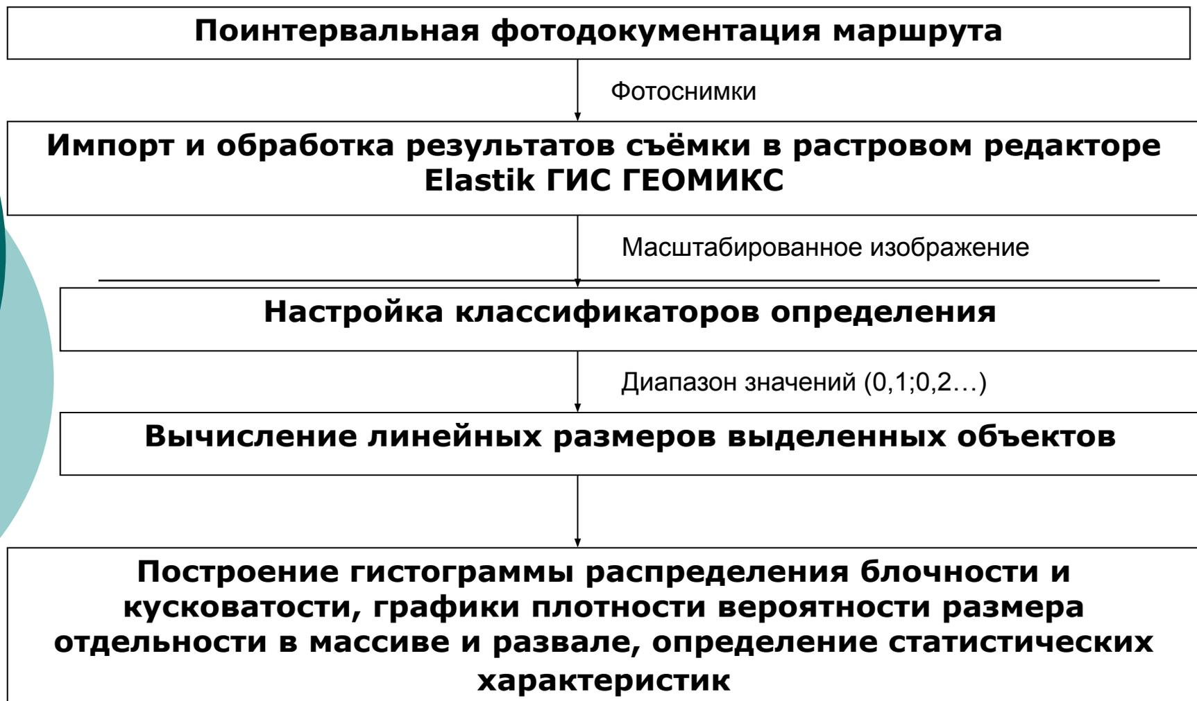
**Блок - схема алгоритма оценки блочности пород в уступах карьера и кусковатости взорванной горной массы по фотоснимку**
