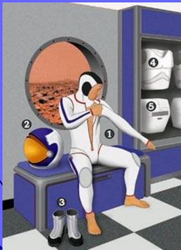
*Основные части биоскафандра (по порядку): "вторая кожа", шлем, ботинки, механическая защита торса, система жизнеобеспечения (иллюстрация с сайта [mvl.mit.edu](http://mvl.mit.edu)).*
