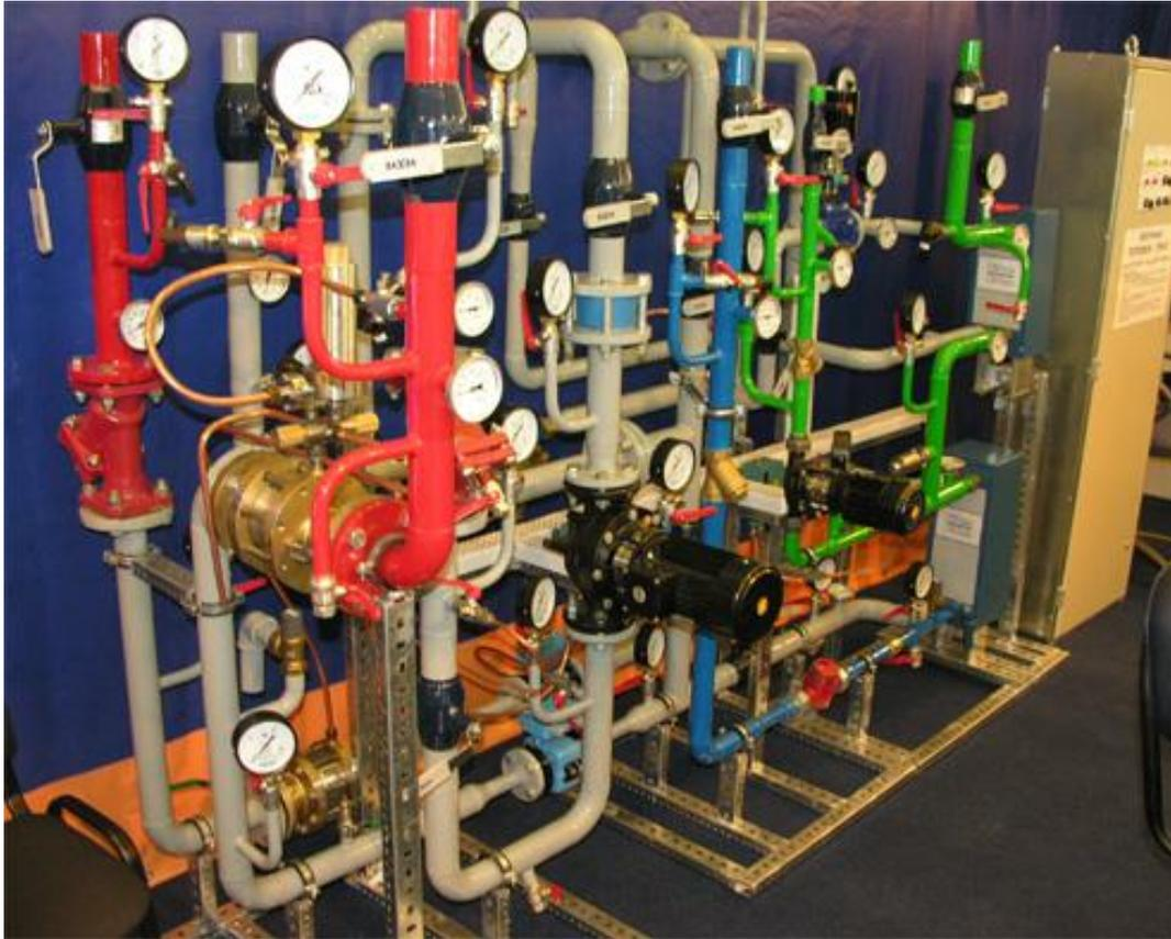
При внедрении БТП (блочный тепловой пункт) полной заводской готовности используется наиболее эффективное и надежное оборудование – пластинчатые теплообменники, малощумные насосы и другое оборудование.
