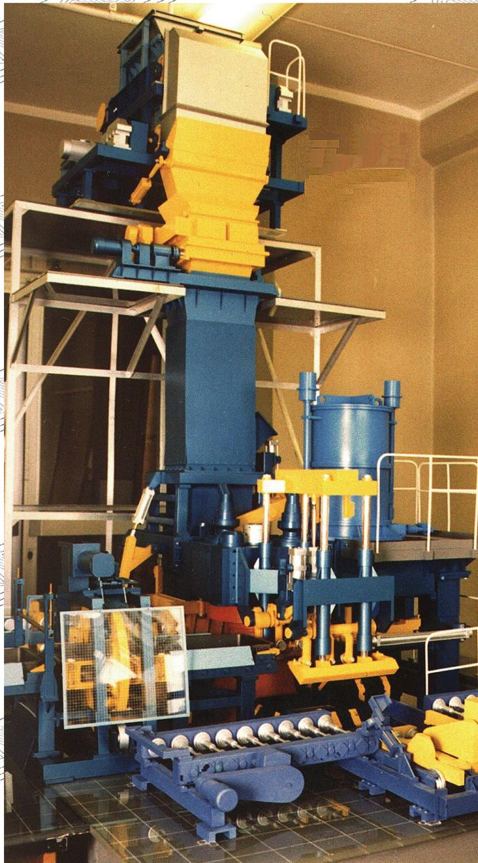
**Двухпозиционные формовочные машины предназначены для замены устаревшего формовочного оборудования в действующих литейных цехах.**
