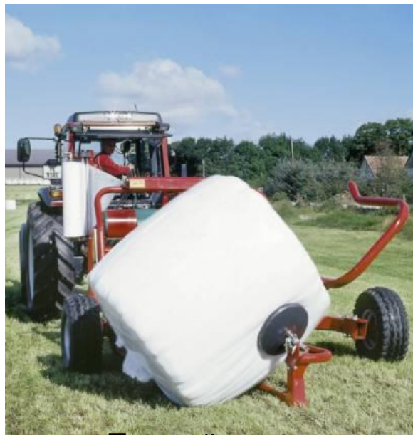
Полный контроль за рулоном во время разгрузки
