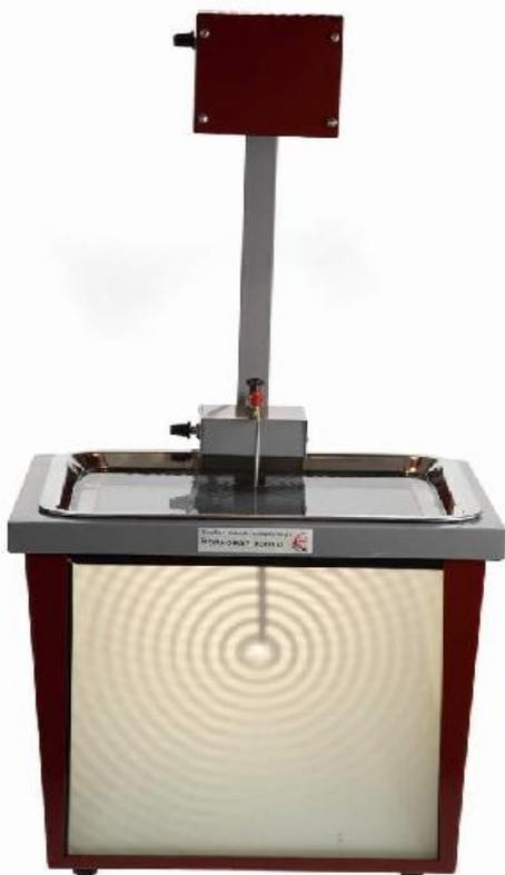
**предназначен** для моделирования колебательных и волновых движений на плоскости при проведении демонстрационных экспериментов по теме «Механические колебания и волны». Наблюдаются естественные поверхностные волны создаваемые мультивибратором. Волны "замораживаются" стробоскопом и мы можем изучать свойства их распространения.
