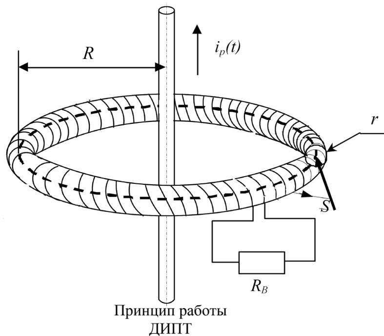
Традиционная катушка ДИПТ состоит из провода, намотанного на немагнитный сердечник (относительная магнитная проницаемость  $\mu_r=1$ ). Катушка затем размещается вокруг проводников, токи которых необходимо измерить.
