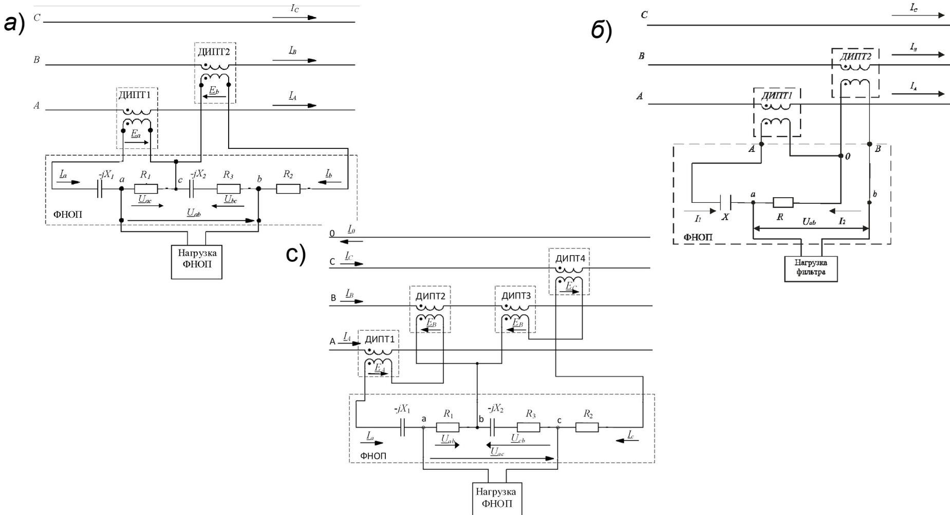
Схемы измерительных преобразователей тока обратной последовательности:
