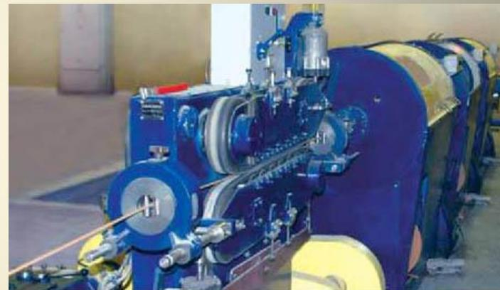
Обмоточная машина ОГ-12
