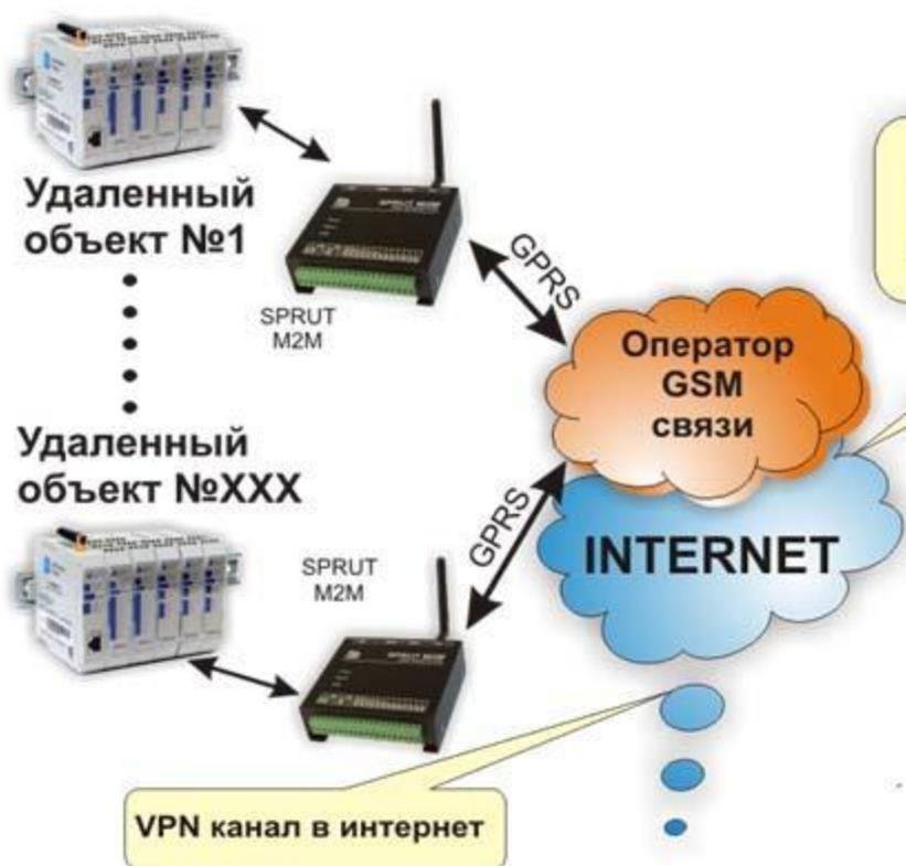
Для повышения надёжности GPRS систем рекомендуется использование выделенного APN сервера и VPN канала
