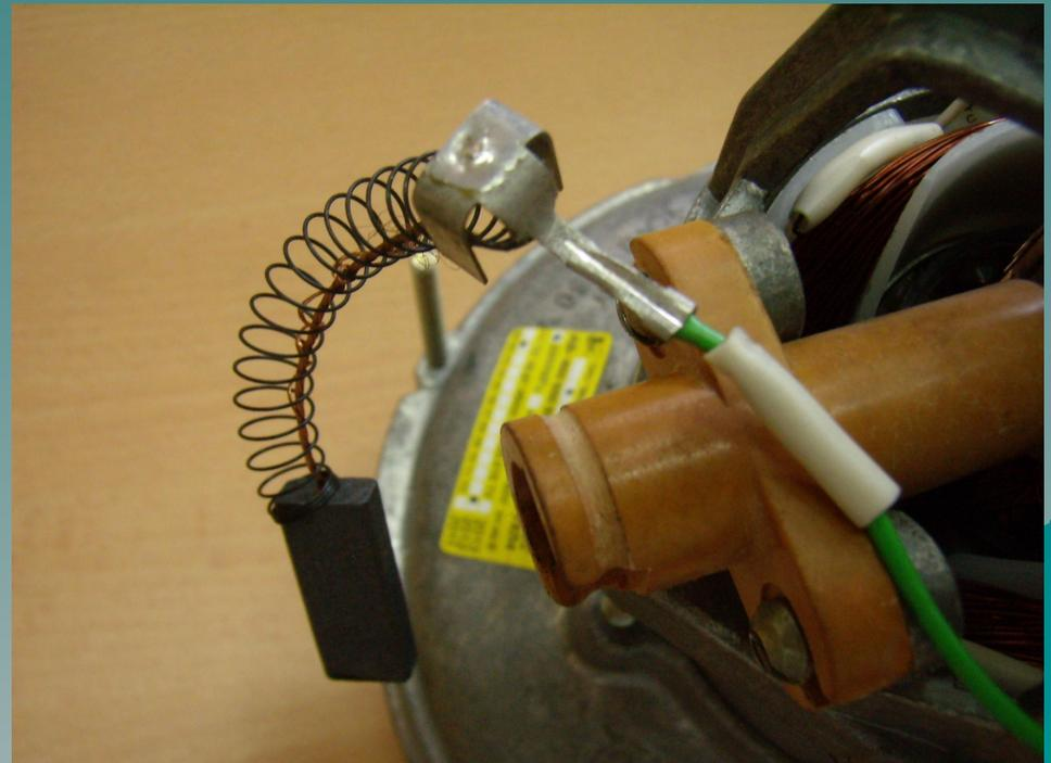
4. Отпаять поводок от контактной площадки (место указано). От новой щетки также отпаять поводок от контактной площадки и припаять вместо снятой.
