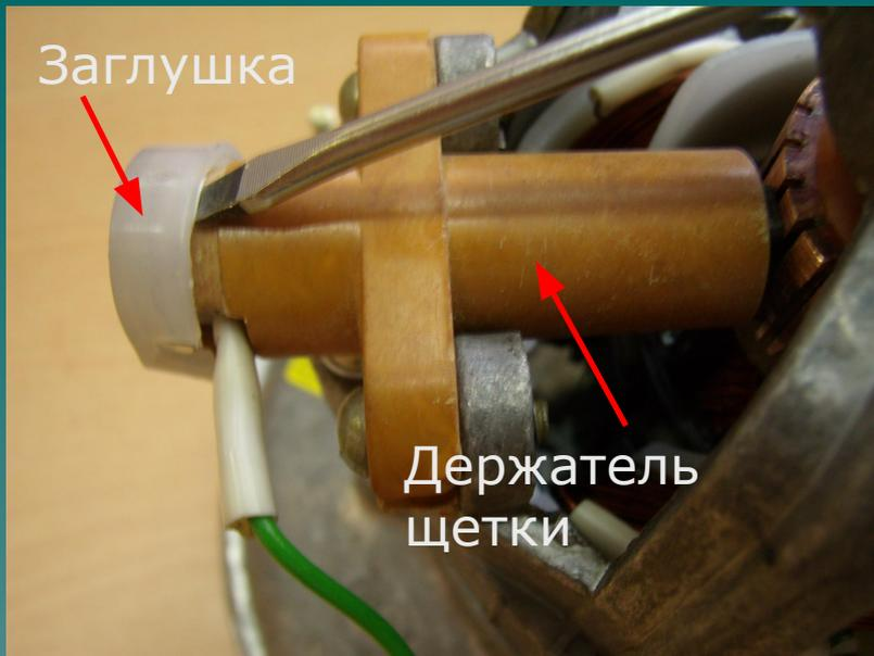
2. С помощью инструмента (отвертки) снять пластмассовую заглушку с держателя щетки.
