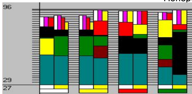
Рисунок 4 – Контурная характеристика ТГ-2, после его ремонтов и вибронатадки: по оси абсцисс – уровень источника (дБ); по оси ординат – точки контроля 1,2...7
