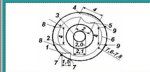
1 - отражателя (след неустойчив), 2 - краев паза в затворе под отражатель (след неустойчив), 3 - бойка, 4 - защелка выбрасывателя, 5 - краев выемки в зеркале затвора, 6 - ступенчатого выступа зеркала затвора, 7,8,9 - краев пазов в стенке чашки затвора (следы неустойчивы)
