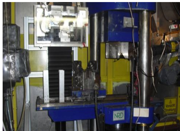
Энергодисперсионный рентгеновский дифрактометр при высоких давлениях и температурах в экспериментальном канале F2.1 (DESY, Hamburg, Germany)
