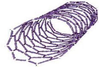
Однослойные углеродные нанотрубки (диаметр 1 nm)
