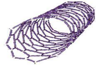
Однослойные углеродные нанотрубки (диаметр 1 nm)
