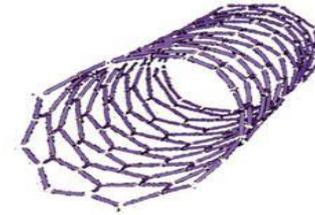
Однослойные углеродные нанотрубки (диаметр 1 nm)
