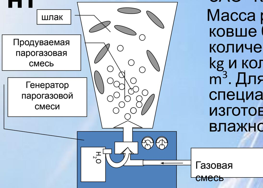
В 2003 был проведен эксперимент на 16,5 МВт электротермической печи на ЗАО “Кремний” (г.Шелехов). Масса расплава кремния в ковше была 3000 kg, количество водяного пара 9 kg и количество воздуха 206  $m^3$ . Для эксперимента был специально разработан и изготовлен генератор влажности.
