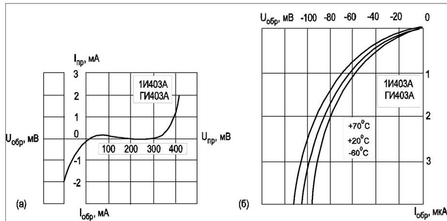
**Рис. 4.19. Вольт-амперная характеристика германиевого обращенного диода ГИ403**
