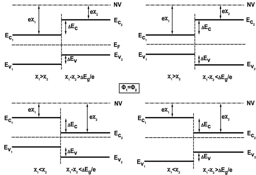
Рис. 2.13. Зонные диаграммы гетеропереходов при различных комбинациях  $E_g$  и  $\chi$  в случае равенства термодинамических работ выхода  $\Phi_1 = \Phi_2$ .
