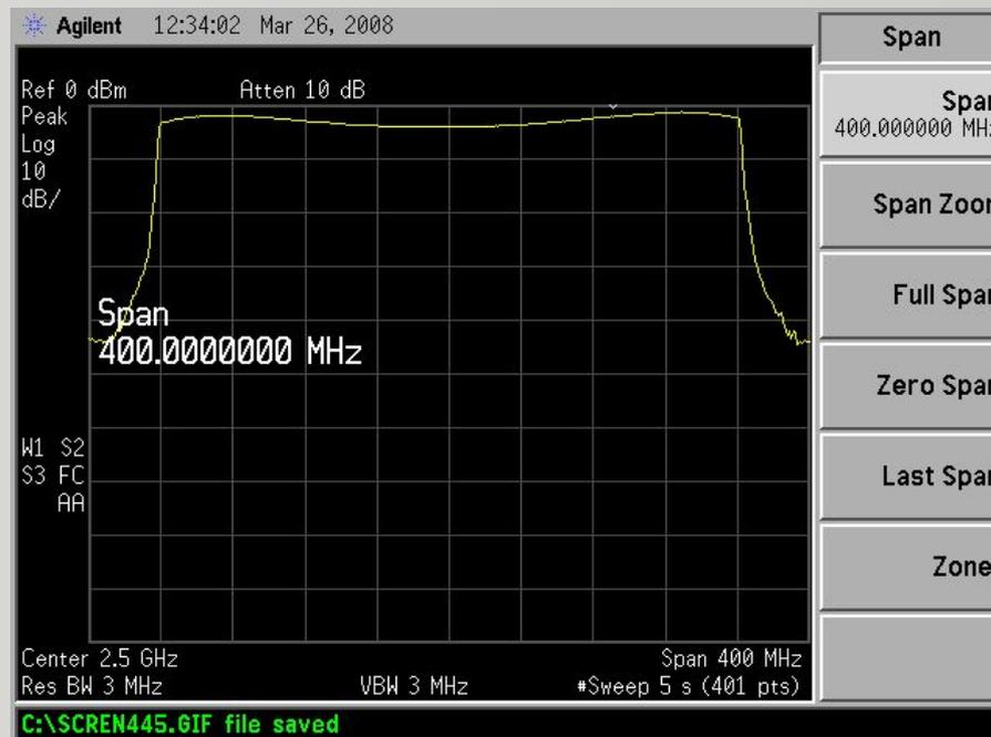
Микросхема 1508ПЛ8Т позволяет формировать ЛЧМ сигнал с полосой до 400 МГц, а при использовании квадратурного переноса — до **800** МГц
