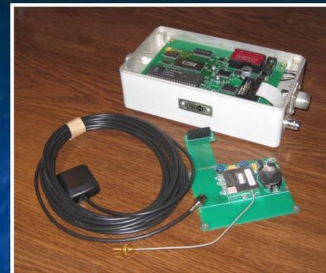
Регистратор DLPOS предназначен для полевых (пикет-маршрутных, GPS) наземных работ и вариационных измерений. Используется на контрольных пунктах и при магнитной очистке территории обсерваторий
