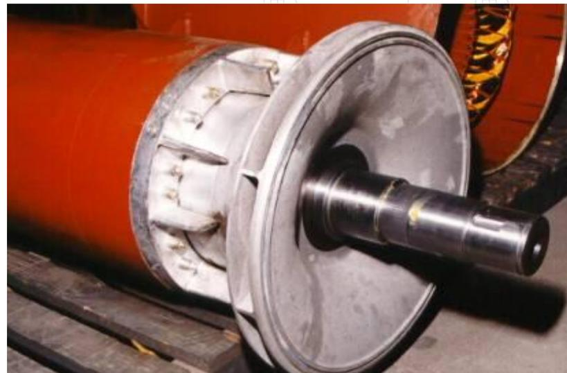
**Дополнительный внутренний вентилятор обеспечивает улучшенное охлаждение обмоток**
