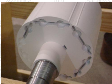
Высокоэнергетичные магниты внутри ротора
