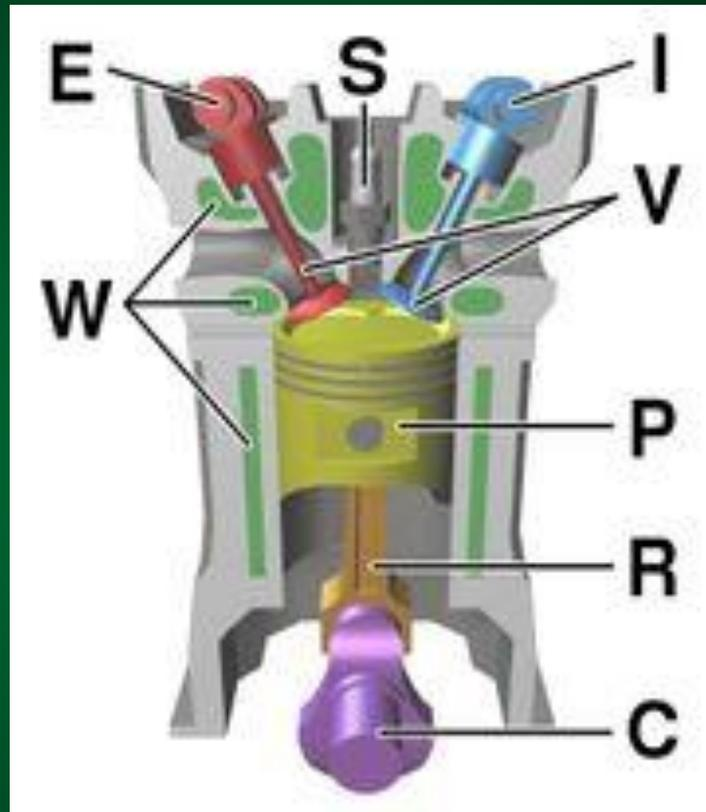
(E) выпускная камера, (I) впускная камера, (S) свеча, (V) впускной и выпускной клапан, (P) поршень, (R) шатун, (C) коленвал, (W) рубашка с охлаждающей жидкостью.
