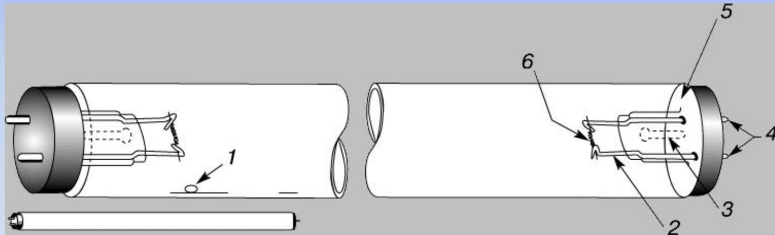
1 - ртуть; 2 - штампованная стеклянная ножка с электровводами; 3 - трубка для; 4 - выводные штырьки; 5 - концевая панелька; 6 - катод
