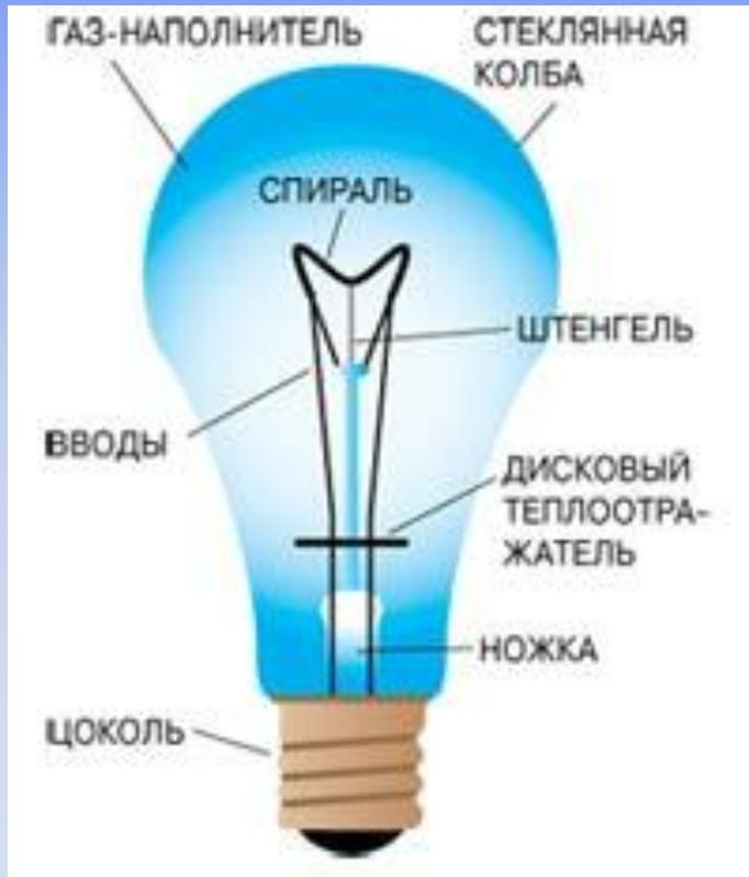
Лампа накаливания — электрический источник света, в котором тело накала нагревается до высокой температуры за счёт протекания через него электрического тока, в результате чего излучается видимый свет.
