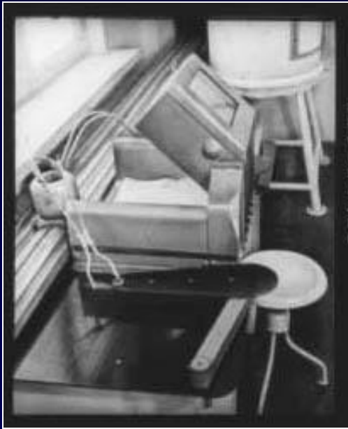
Радиоманипуляционный стол с дистанционными минцетами перед автоматической линией передачи контейнеров
