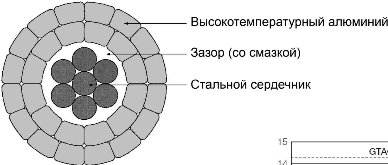
Нагрузка только на сердечнике при  $T > T_{\text{монтажа}}$ , алюминий не нагружен
