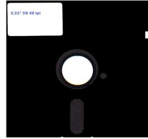
FDD бывают двух размеров: рассчитанные на дискеты 3,5" и 5,25" плотности DD (двойной плотности) и HD (высокой плотности). Способ записи на дискеты – намагничивание отдельных участков..
