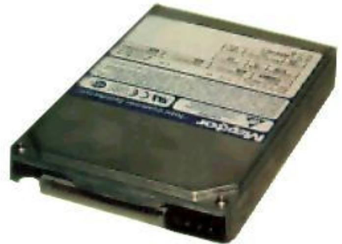
Винчестер состоит из не скольких жестких (чаще алюминиевых) дисков, с нанесенным на поверхность магнитным слоем и расположенных друг под другом. Каждому диску соответствует пара головок записи/чтения. Зазор между головками и поверхностью дисков составляет 0,00005–0,00001 мм. Скорость вращения дисков в зависимости от модели находится в пределах 3600–7800 об./мин.
