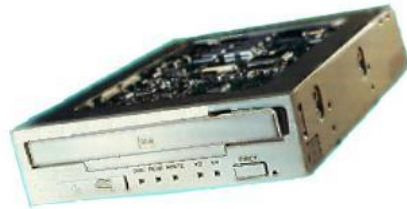
Цифровые данные хранятся в виде чередующихся между собой по ходу спирали ямок, нанесенных на поверхности полиуглеродного пластика и ровных областей. Поверх этого пластикового слоя для лучшего отражения напыляется тонкий слой алюминия или золота, который также покрывается защитным слоем прозрачного пластика. Стандартные CD могут хранить до 700 Мбайт цифровой информации.
