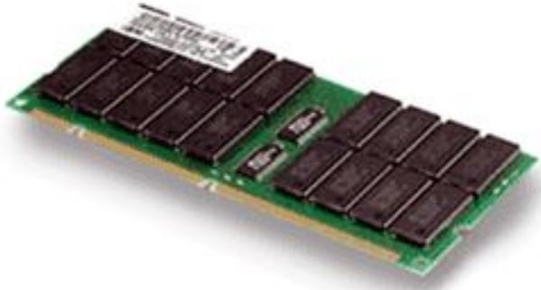
В системную плату модули SIMM необходимо было вставлять только попарно, а DIMM можно выбрать по одному, что связано с разрядностью внешней шины данных процессоров Pentium. Такой способ установки предоставляет больше возможностей для варьирования объема оперативной памяти.
