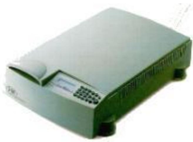
Планшетные сканеры осуществляют сканирование в автоматическом режиме. Оригинал располагается в сканере на стеклянном листе, под которым головка чтения с CCD-элементами сканирует изображение построчно с равномерной скоростью. Размеры сканируемых изображений зависят от размера сканера и могут достигать размеров большого чертежного листа (A0). Специальная слайд-приставка позволяет сканировать слайды и негативные пленки. Аппаратное разрешение планшетных сканеров достигает 1200 dpi.
