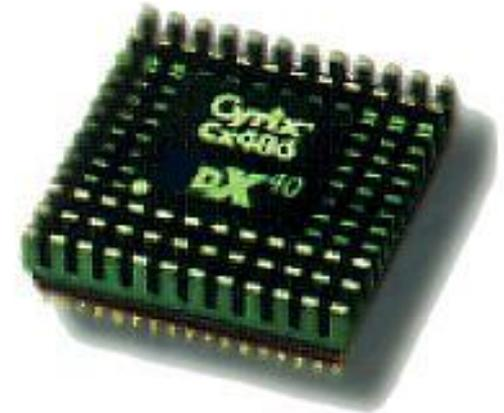
*Тактовая частота указывает, сколько элементарных операций (тактов) микропроцессор выполняет за одну секунду (измеряется в МГц).*
