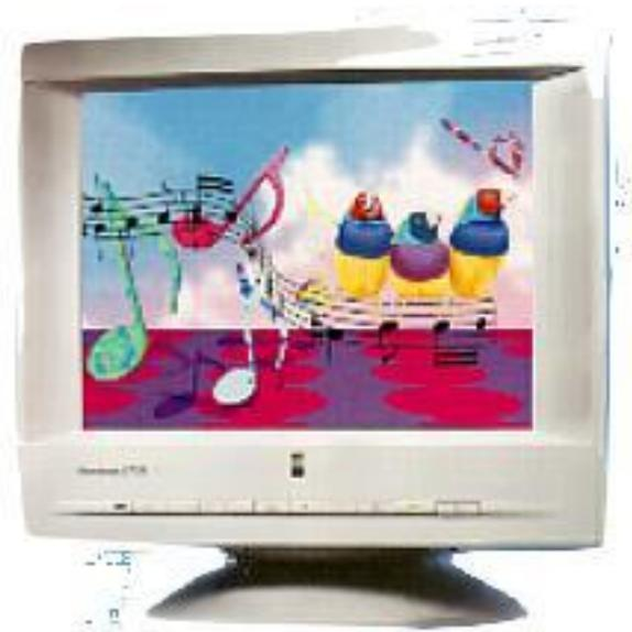
Все современные аналоговые мониторы условно можно разделить на следующие группы: с фиксированной частотой развертки, с несколькими фиксированными частотами и многочастотные (мультичастотные).
