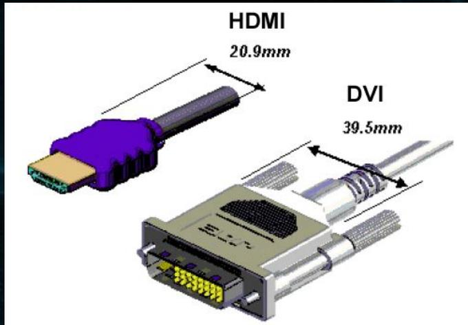
Для подключения внешних видеоустройств на видеокартах, могут использоваться аналоговые интерфейсы VGA, RCA, S-Video и цифровые - DVI и HDMI:
