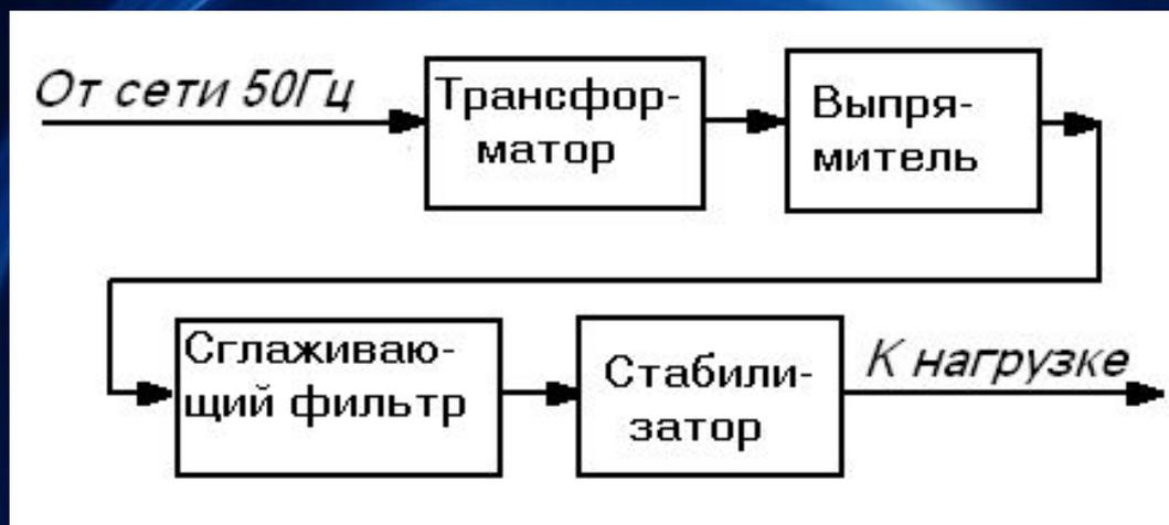
Трансформатор предназначен для гальванической развязки питающей сети и нагрузки и изменения уровня переменного напряжения. Обычно трансформатор является понижающим. Выпрямитель преобразует переменное напряжение в напряжение одной полярности (пульсирующее). Сглаживающий фильтр уменьшает пульсации напряжения на выходе выпрямителя. Стабилизатор уменьшает изменения напряжения на нагрузке (стабилизирует напряжение), вызванные изменением напряжения сети и изменением тока, потребляемого нагрузкой.
