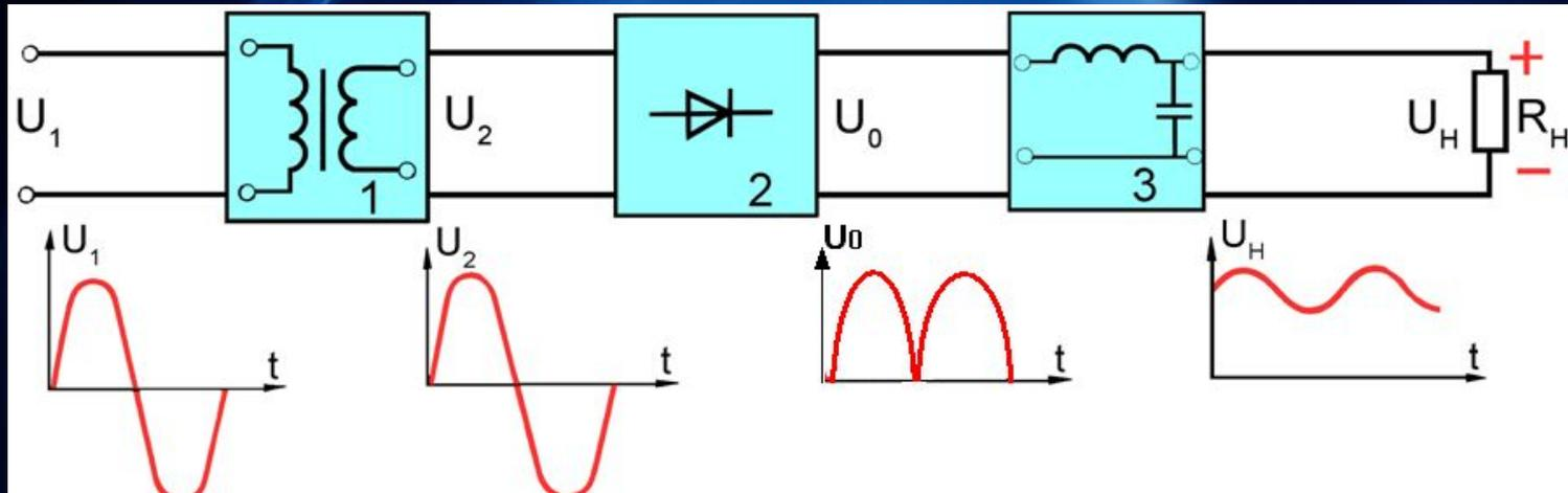
Выпрямитель состоит из силового трансформатора (1), понижающего напряжение в сети, схемы выпрямителя (2), преобразующего переменное напряжение  $U_2$  в пульсирующее  $U_0$ , постоянного по направлению, и сглаживающего фильтра (3).
