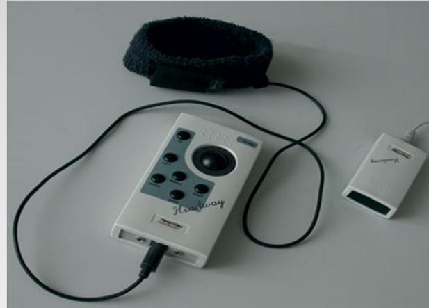
**Головные мыши**, управляемые движением головы, представляют собой беспроводное оптическое следящее сенсорное устройство для людей, которые не могут работать с помощью рук. Устройство фиксирует движения головы, используя их для непосредственного управления указательной стрелкой мыши на мониторе компьютера.
