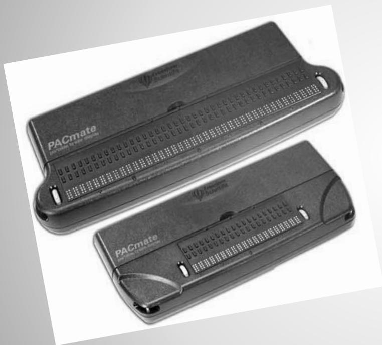
Электронные записные книжки для слепых позволяют им набирать **шрифтом Брайля** заметки, номера телефонов, адреса и т.д., а затем вызывать нужную запись или переносить их в компьютер для последующего преобразования в обычный текст или в речь. Такая записная книжка может быть подсоединена к любому персональному компьютеру и, в комплекте с программой экранного доступа, преобразовать его в рабочее место слепого пользователя. Многоязыковая поддержка вывода речевой информации.
