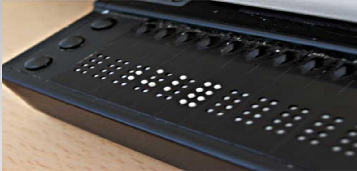
**Брайлевский дисплéй** — устройство ввода, предназначенное для отображения текстовой информации в виде шеститочечных символов **азбуки Брайля**. Брайлевские дисплеи делают возможным использование современных компьютеров **незрячим** и слабовидящим людям.
