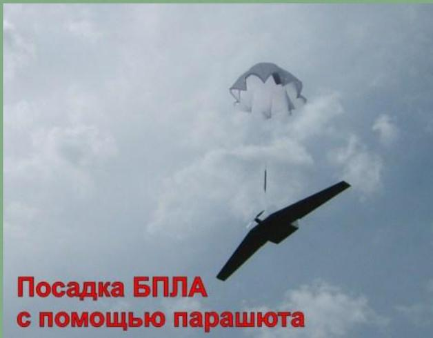
**Посадка БПЛА с помощью парашюта**
