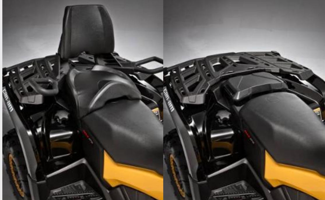
Система трансформации заднего сиденья в багажную площадку (CRS)
