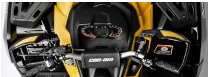
Руль из конического алюминиевого профиля с квадратной клавиатурой
