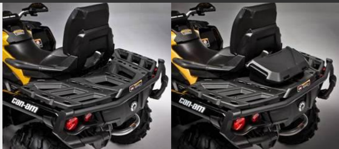
Система трансформации заднего сиденья в багажную площадку (CRS)
