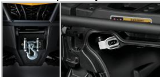
Лебёдка WARN ® на 3000 фунтов с роликовым тросоукладчиком, проводным пультом дистанционного управления и внутренним отсеком для хранения пульта
